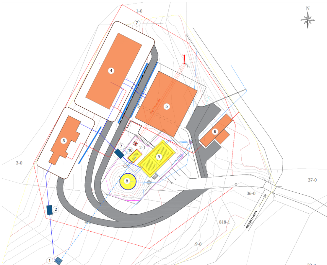
Figura 13. Propozimi i detajuar për instalimin e rezervuarit të ujit (ngjyra portokalli) krahas sistemit ekzistues (ngjyra e verdhë)
