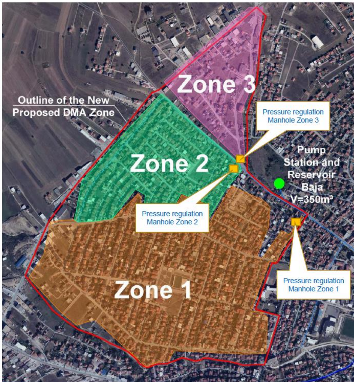
Figura 14. Zona DMA e pilotimit në Gjilan me tri nën-zona
